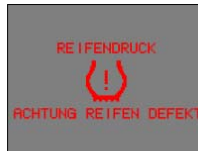
Давление в шинах Внимание шины повреждены Быстрая потеря давления >0,2 бар/мин
