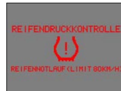
Система контроля давления в шинах Аварийный режим (предел скорости 80км/ч)
