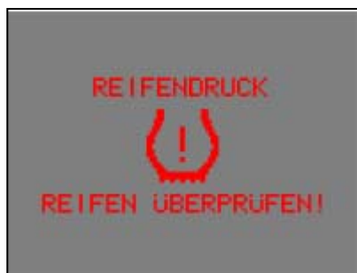
Давление в шинах Проверить шины Потеря давления >0,4 бар
