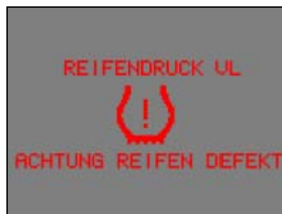
Давление в передней левой шине Внимание шина повреждена
